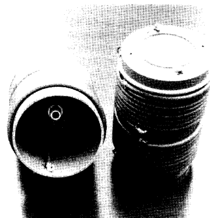
Fig. 31. De baluns in werkelijkheid. De aansluitklemmen voor de ramen zijn gemerkt met A en B. Wanneer de baluns aan de draagbuis worden opgehangen moet A van de ene balun aan dezelfde kant komen als B van de andere.
